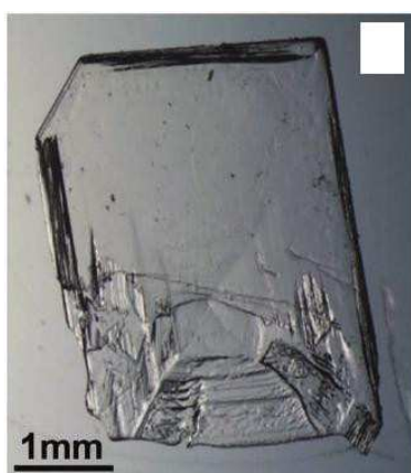
Figuur 1: Een uit oplossing gegroeid 4HCB-kristal (links) en zijn response bij aangelegde spanning 500V op verschillende dosistempo's bij 35keV straling met verschillende contacten (rechts) [figuur samengesteld uit Ref[1]]
